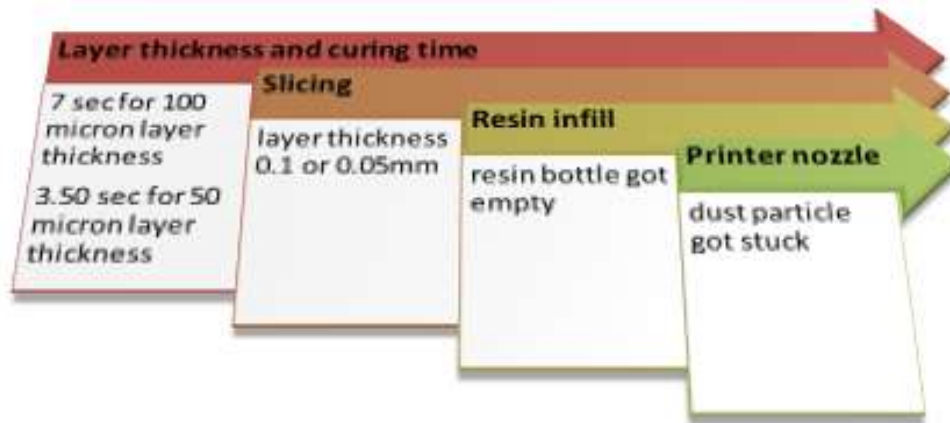
Fig 4.16 Printing error parameters
